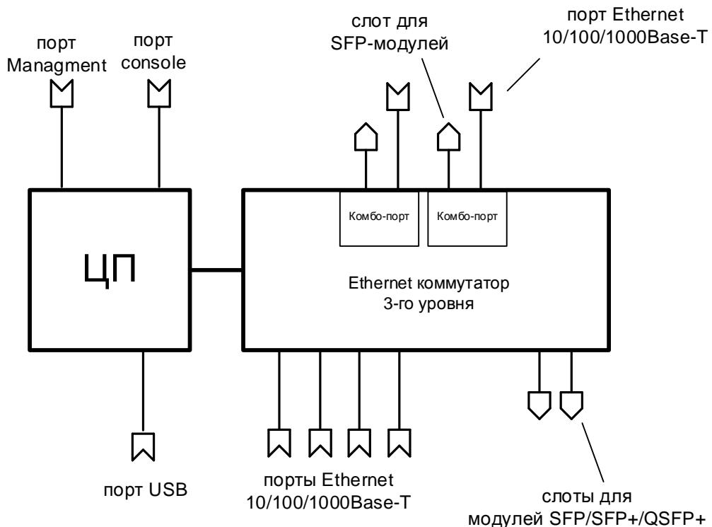
Рис. 2 — Структурная схема коммутаторов ZES-30xx
