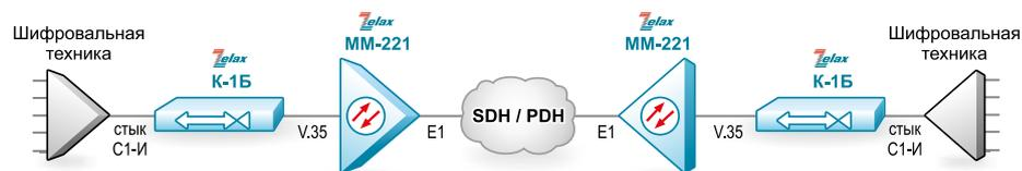
Встроенный синхронно-асинхронный преобразователь обеспечивает возможность связи асинхронных устройств (например, персональных компьютеров) через аппаратуру со стыком С1-И.
