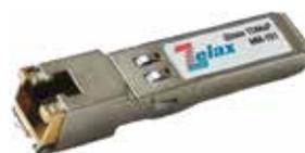
Шлюзы TDMoP MM-101 — компактное решение для передачи одного или двух потоков G.703/E1 по сети с коммутацией пакетов
