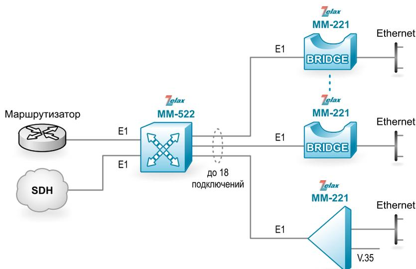
Агрегирование до 18 различных подключений по частичным потокам E1
