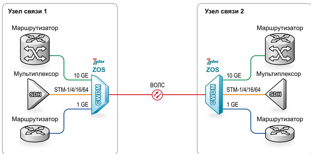
Предоставление различных каналов на базе одной ВОЛС
