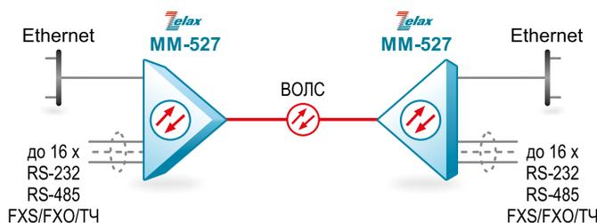
Передача шестнадцати пользовательских интерфейсов (RS-232/485 и FXS/FXO/ТЧ) и данных Ethernet по волоконно-оптической линии связи
