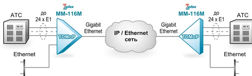
Передача потоков E1 через IP/Ethernet-сеть
