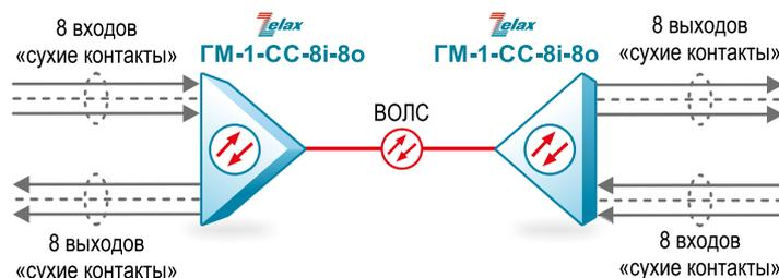
Организация передачи и приёма состояний 8-и интерфейсов «сухие контакты» по ВОЛС
