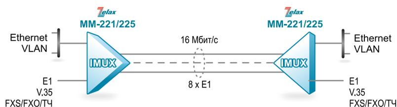
Передача высокоскоростного канала Ethernet через 4 канала E1
