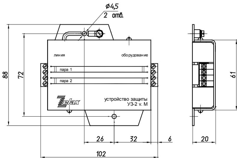
Рис. 3 Внешний вид и габариты устройства УЗ-2-М
