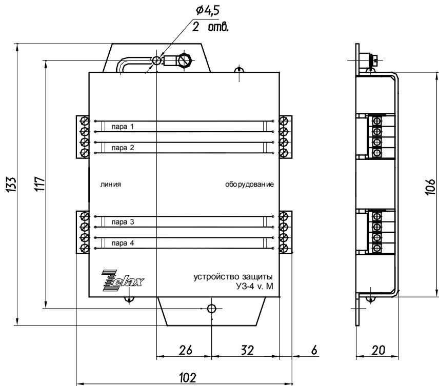
Рис. 4. Внешний вид и габариты устройства УЗ-4-М
