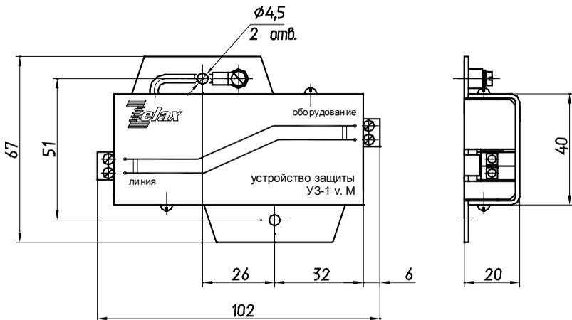
Рис. 2 Внешний вид и габариты устройства УЗ-1-М
