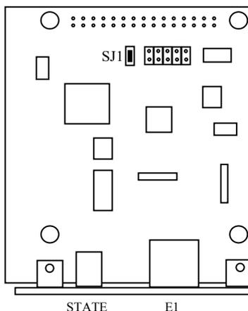
Рис.3. Место установки джампера SJ1 на плате модуля МПГ-Е1.
