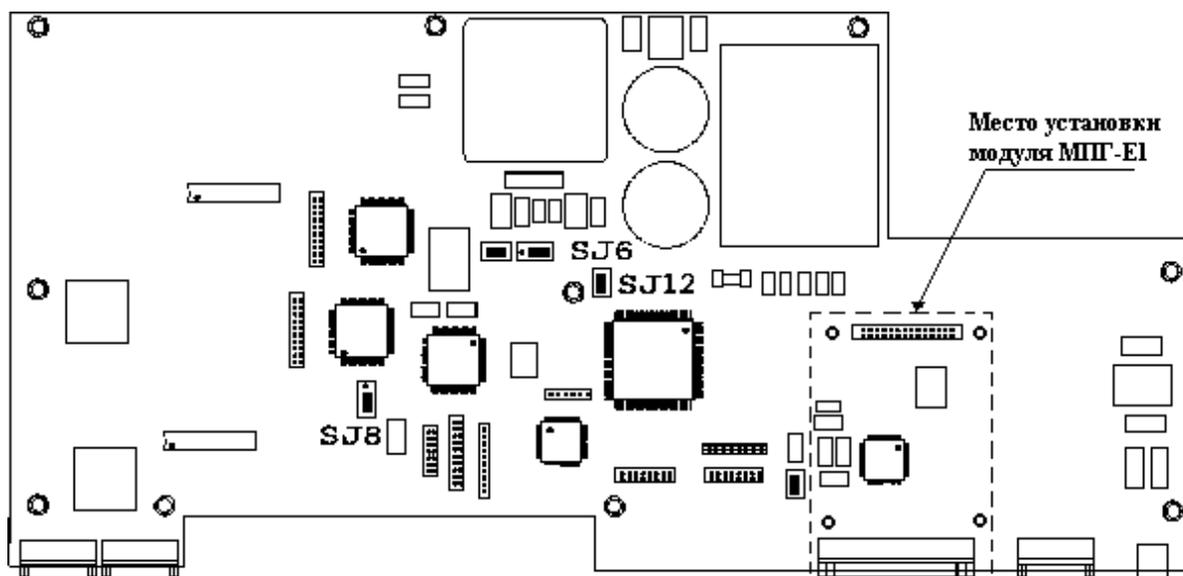
Рис.2. Место установки модуля МПГ-Е1 на плате модема.
