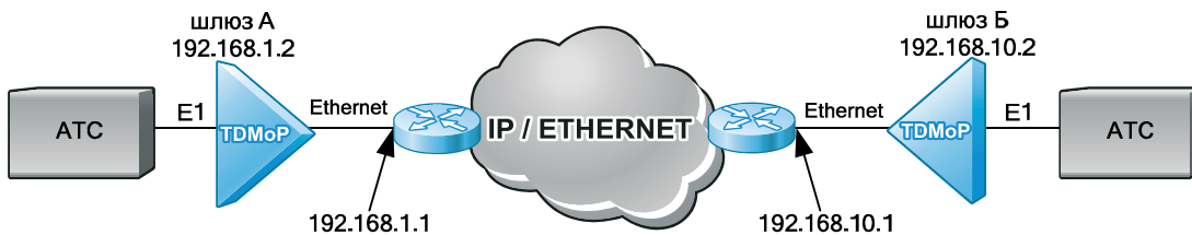
Рис. 2. Схема передачи потока E1 через сеть IP/Ethernet
