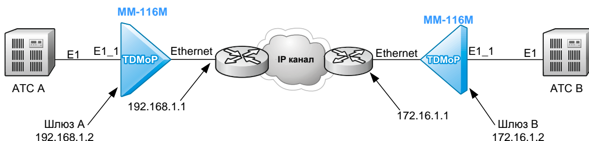
Рис. 2. Передача потока E1 через IP сеть, трафик управления и данные E1 передаются в не тегированных кадрах, шлюзы в разных IP подсетях
