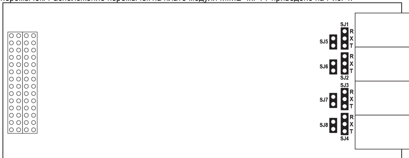
Рис. 4 – Расположение переключателей на модуле MIME-4хРТТ
