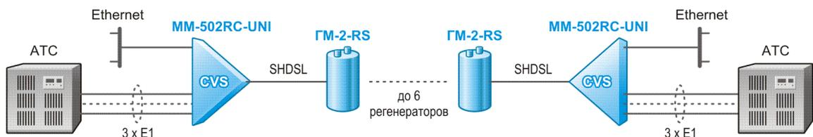
Рис. 6. Передача четырех полных потоков E1 и данных Ethernet по одной витой паре с использованием регенераторов для увеличения дальности связи
