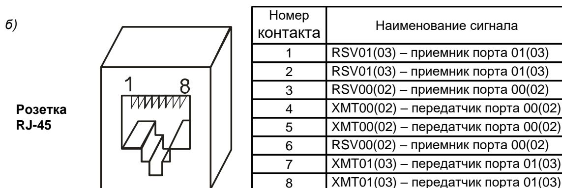
Рис. 7. Назначение контактов разъема порта модулей “E1A”
