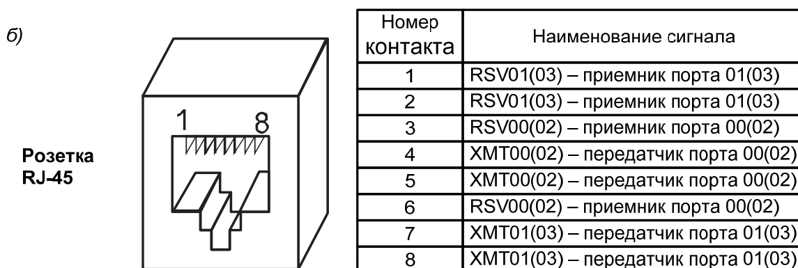
Рис. 7. Назначение контактов разъема порта модулей “E1A”
