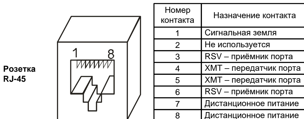
Рис. 6. Назначение контактов разъема портов модулей “G703”, “G703L” и “ИКМ-15”
