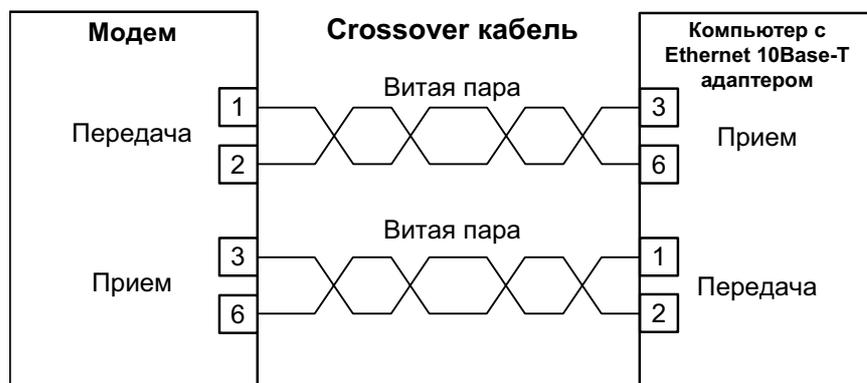
Рис. 7. Подключение модема с одним Ethernet разъемом к компьютеру с сетевым адаптером Ethernet 10Base-T
