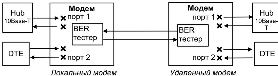
Рис. 11. Проверка в режиме *Point to point BERT*
