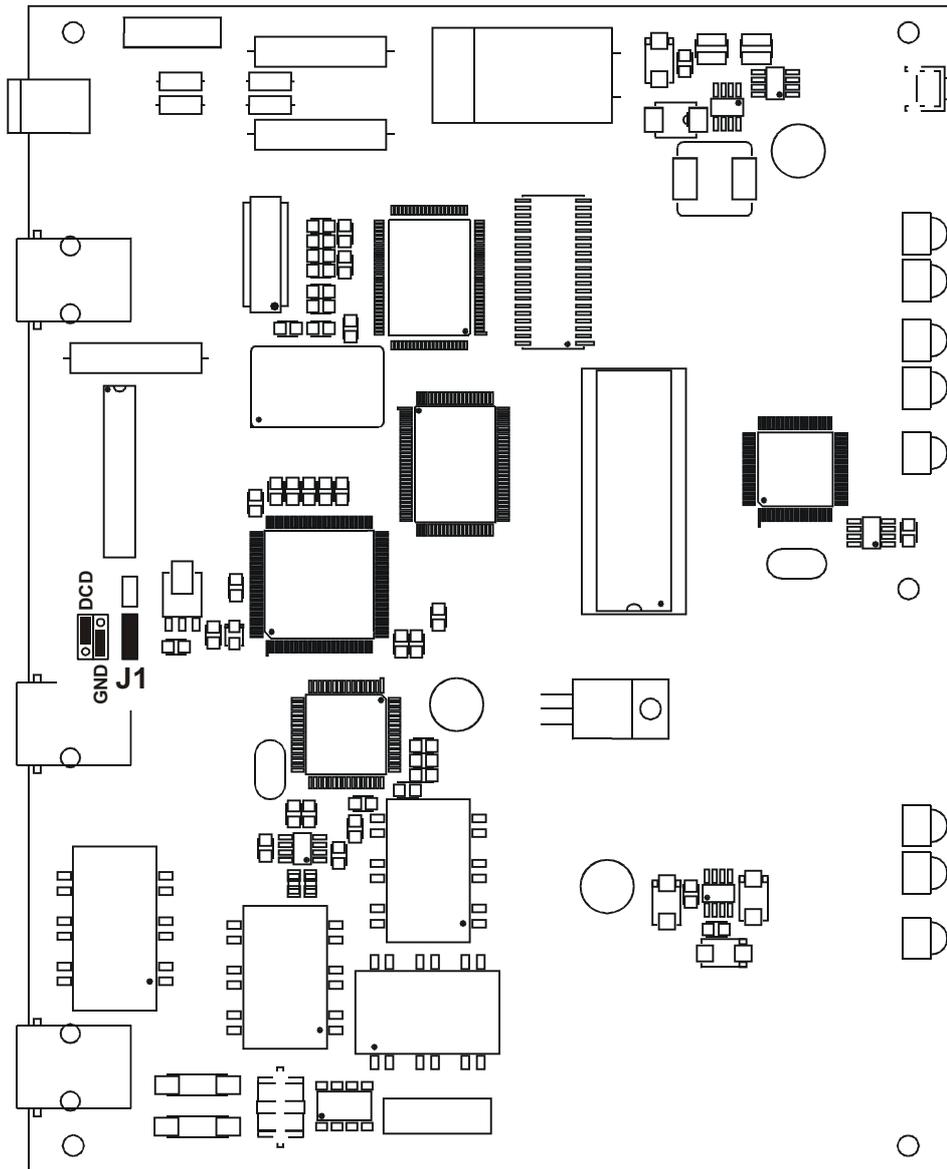
Рис. 5. Расположение элементов на плате модема
