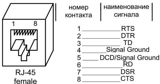
Примечание: Функция сигнала DCD/Signal Ground зависит от перемычки J1. См. П.4.4 на стр.10.
