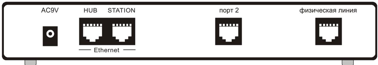
Рис. 4 Задняя панель с двумя разъемами Ethernet модема
