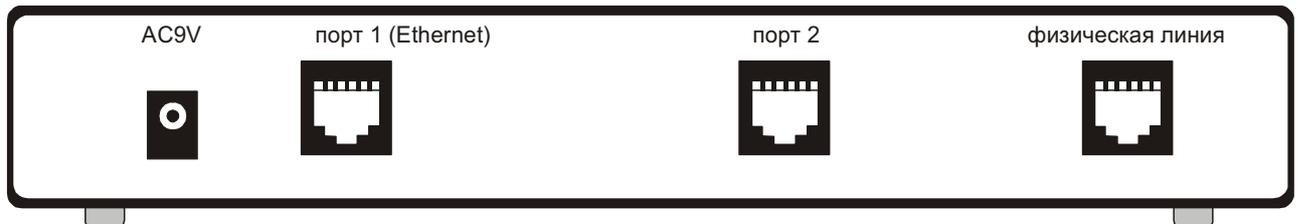
Рис. 3. Задняя панель с одним разъемом Ethernet модема
