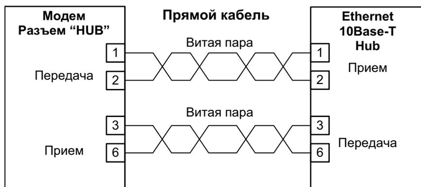
Рис. 6. Подключение модема с одним или с двумя разъемами Ethernet к Ethernet 10Base-T концентратору
