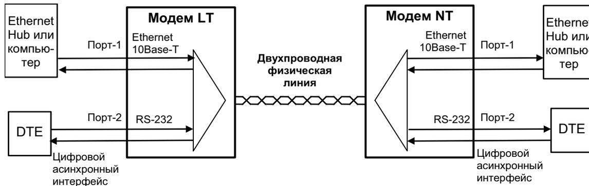
**Рис.1. Структура каналов связи**
