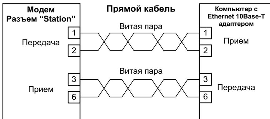
Рис. 8 Подключение модема с двумя разъемами Ethernet к компьютеру с сетевым адаптером Ethernet 10Base-T
