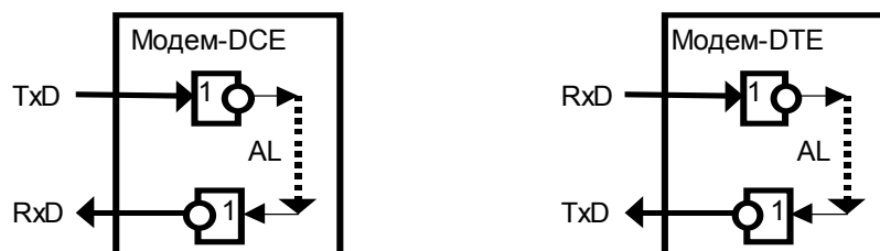
Рис. 29. Включение инверторов для цепей RxD и TxD в тестовых режимах AI, RDL.
