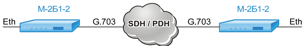
Рис. 6 Использование модема в сети передачи данных SDH/PDH
