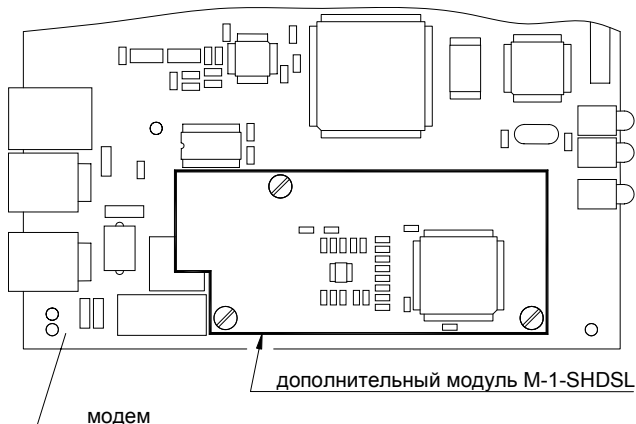
Рис. 1. Установка модуля M-1-SHDSL
