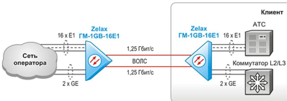
Рис. 6. Высокоскоростное подключение клиента к сети оператора связи
