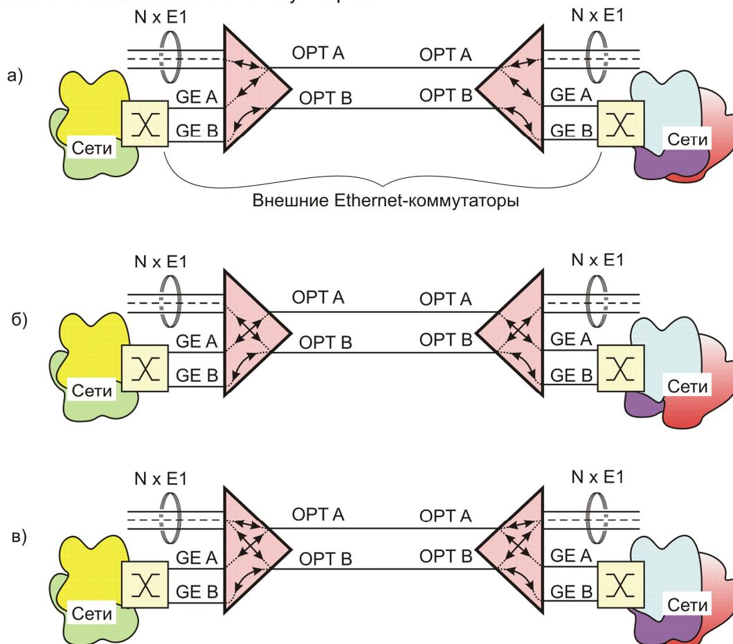
Рис. 16. Примеры использования мультиплексов в системах передачи данных типа «точка — точка» (второй вариант)
