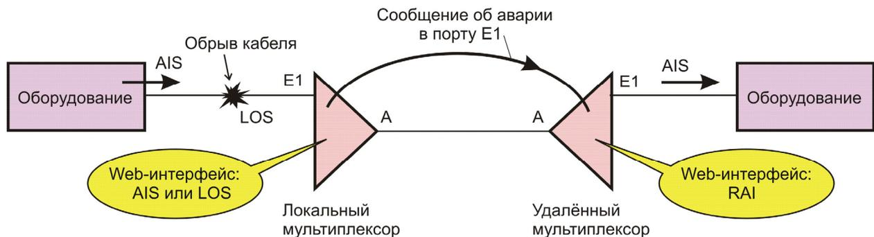
**Рис. 22. Передача сигнала аварии из локального мультиплексора в удалённый**
