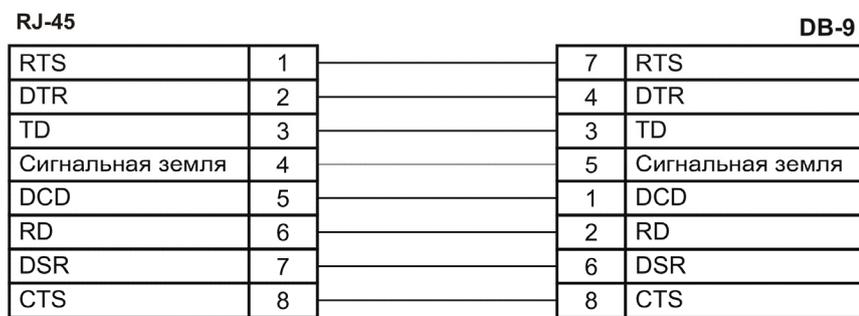
Схема соединительного кабеля A-002. Длина кабеля 2 м
