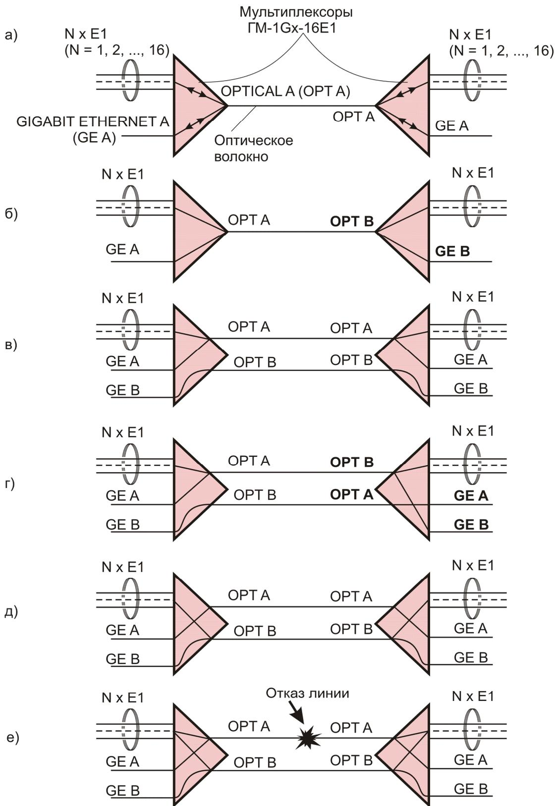
**Рис. 15. Примеры использования мультиплексоров в системах передачи данных типа «точка — точка» (первый вариант)**
