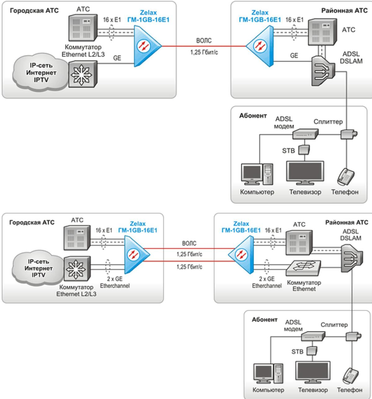
Рис. 1. Объединение городской и районной АТС и передача трафика Gigabit Ethernet для предоставления абонентам услуг IPTV
