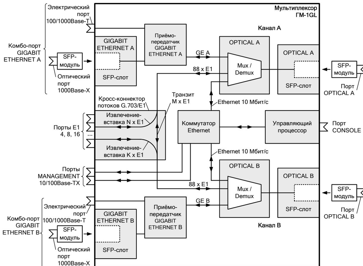
Рис. 9. Функциональная схема мультиплексора ГМ-1GL
