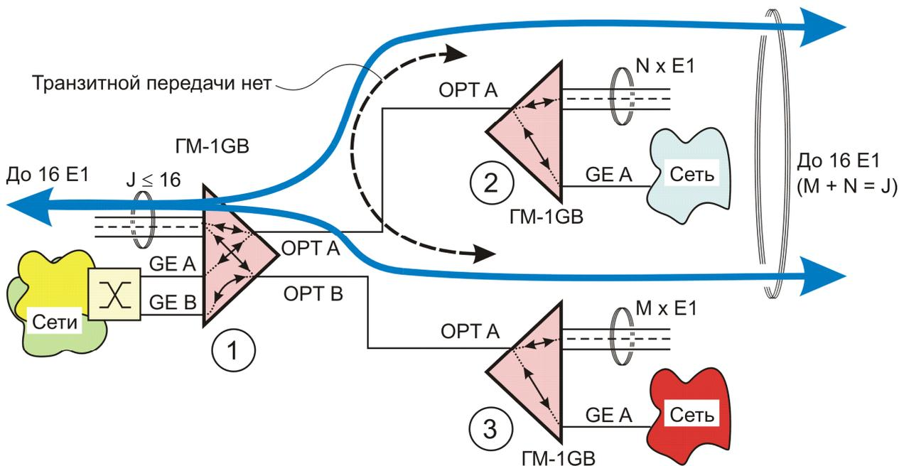
Рис. 17. Примеры использования мультиплексоров ГМ-1GB в системах передачи данных типа «точка — две точки»
