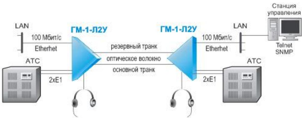
**Рис. 2. Вариант применения мультиплексора ГМ-1-Л2У**
