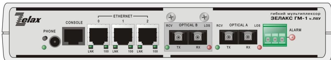
Рис. 8 Лицевая панель мультиплексора ГМ-1-Л8У
