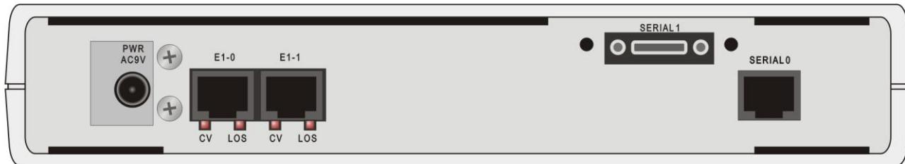
Рис. 9. Задняя панель мультиплексора ГМ-1-Л2У
