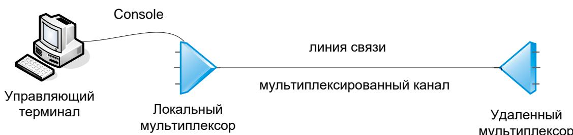
Рис. 12. Подключение управляющего терминала к мультиплексору
