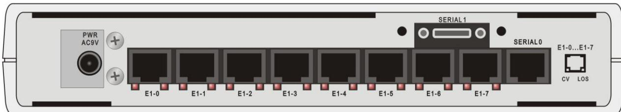
Рис. 11. Задняя панель мультиплексора ГМ-1-Л8У
