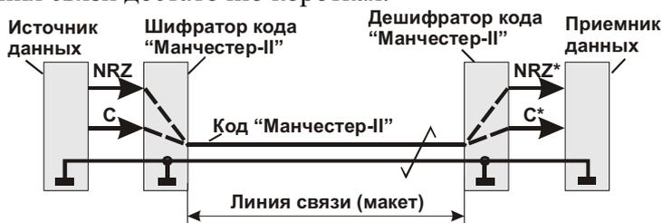
рис. 9.24. Упрощенный пример построения канала связи для передачи данных в коде Манчестер-II (рассмотрено одно направление передачи)
