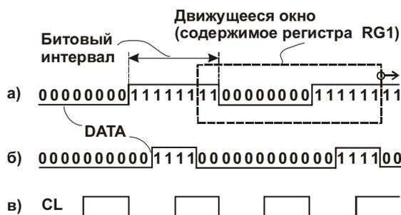
Рис. 9.18. Временные диаграммы, поясняющие принцип действия коррелятора: *а* – сигнал DATA без искажений; *б* – сигнал DATA с искажениями; *в* – восстановленный синхросигнал
