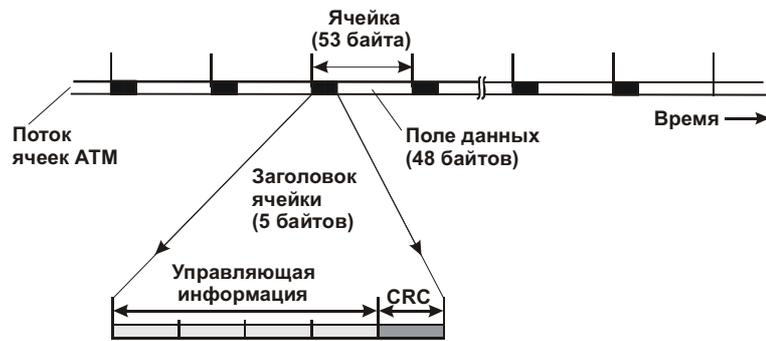
рис. 7.23. Непосредственная передача ячеек ATM по линии связи
