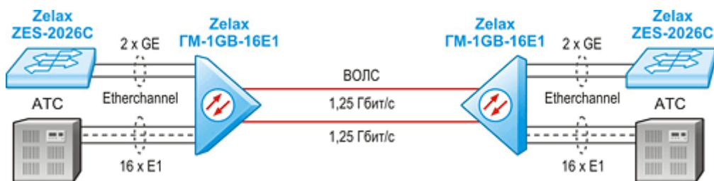
Рис. 2 Совместное использование коммутаторов ZES-2026C и мультиплексов GM-1GB
