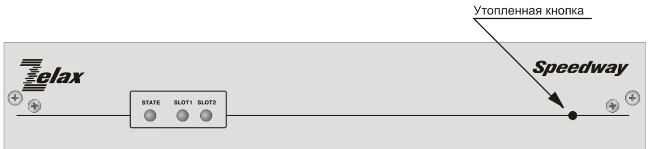
Рис. 17. Вид передней панели изделий MM-2xx для установки в конструктив P-12
