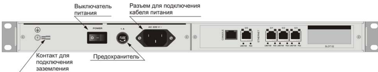
Рис. 30 Вид задней панели изделий MM-205x в металлическом корпусе 19
