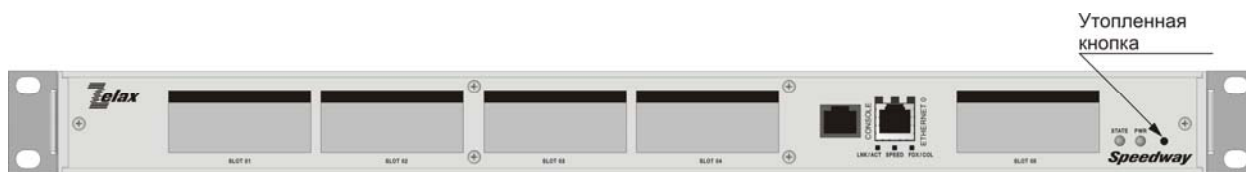
Рис. 20. Вид передней панели изделий MM-502RC-UNI
