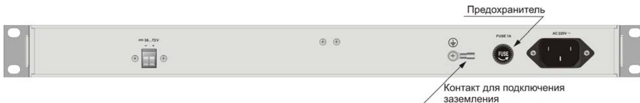
Рис. 33. Вид задней панели изделия MM-502RC-UNI-UPH
