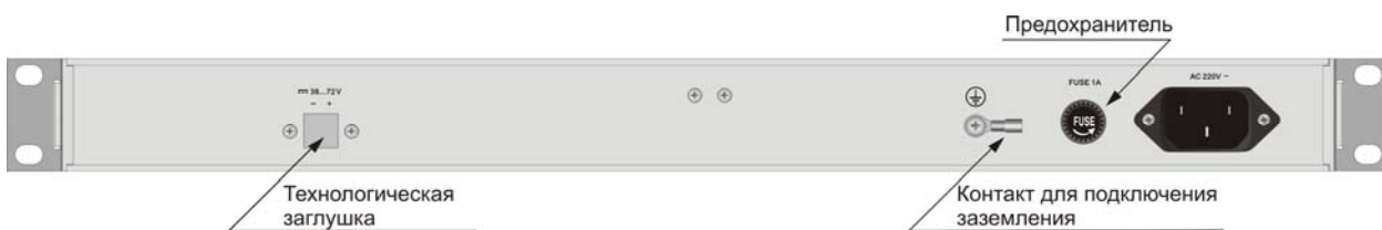
Рис. 31. Вид задней панели изделия MM-502RC-UNI-AC220
