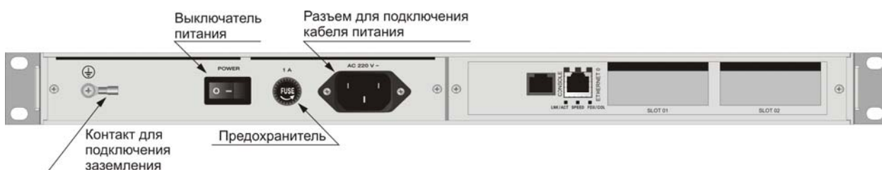
Рис. 25. Вид задней панели изделий MM-201x, MM-202x, MM-211x и MM-212x в металлическом корпусе 19"
