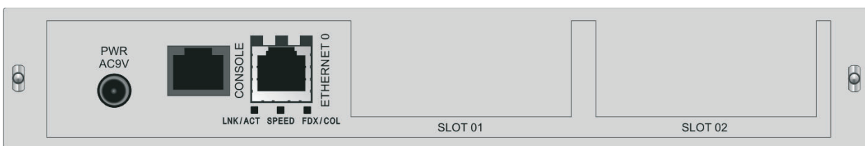
Рис. 23. Вид задней панели изделий MM-221x-I-AC9 и MM-222x-I-AC9 для установки в конструктивы P-12 и P-510 с питанием от сети переменного тока
