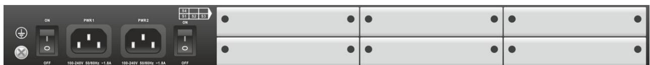
Рис. 9 – Вид задней панели маршрутизатора MM-4112-ACR
