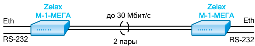
Рис. 2 Передача данных Ethernet и RS-232 по двум медным витым парам на скорости до 30 Мбит/с
