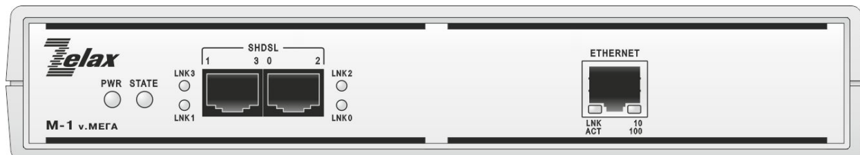
Рис. 7 Вид передней панели SHDSL.bis-модема M-1-МЕГА-4S1E настольного исполнения
