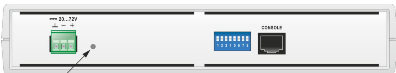
Рис. 9 Вид задней панели SHDSL.bis-модема M-1-MEGA-xS1E-DC60
