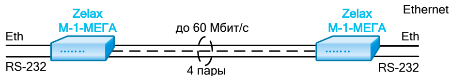
Рис. 3 Передача данных Ethernet и RS-232 по четырем медным витым парам на скорости до 60 Мбит/с
