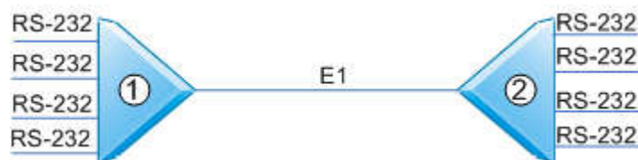
Рис. 41 Передача данных RS-232 через поток E1 в режиме мультиплексирования
