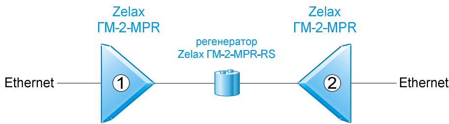
Рис. 40 Передача данных Ethernet по одной медной витой паре в режиме моста с использованием регенератора
