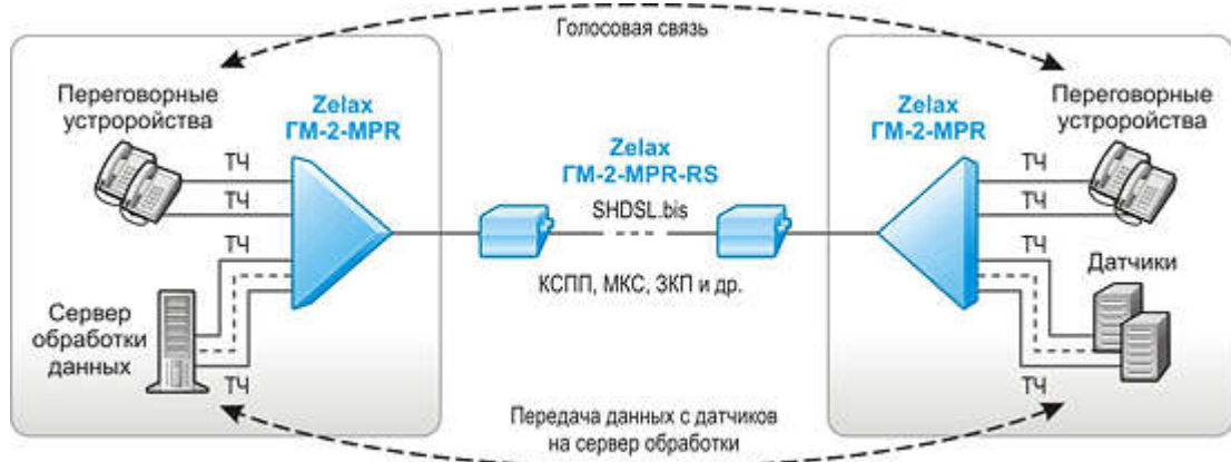
Рис. 5 Организация выделенных 2/4-х проводных каналов ТЧ по медным витым парам
