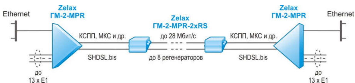
Рис. 2 Передача потоков E1 и данных Ethernet по медным витым парам с суммарной скоростью до 28 Мбит/с
