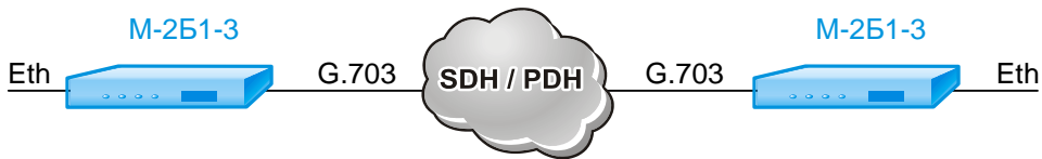
Рис. 7 Использование модема в сети передачи данных SDH/PDH
